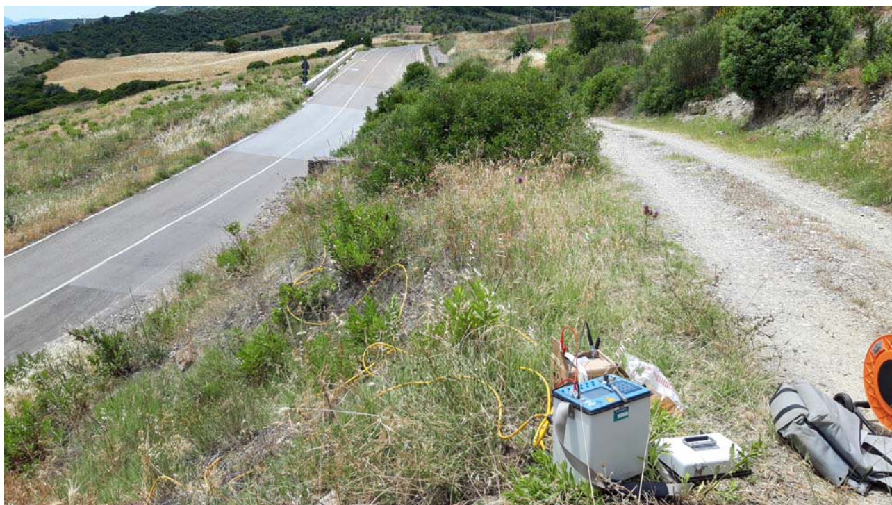
Fig.7) Postazione Tomografia Elettrica TE_3
