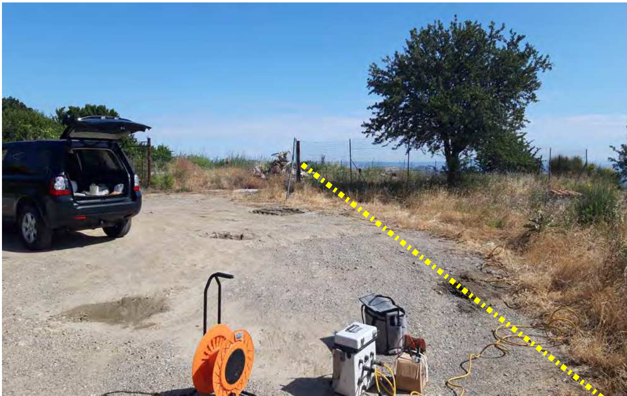
Area di Intervento "I" - Postazione Rilievo Geoelettrico Tomografico TE4 (vista N)
