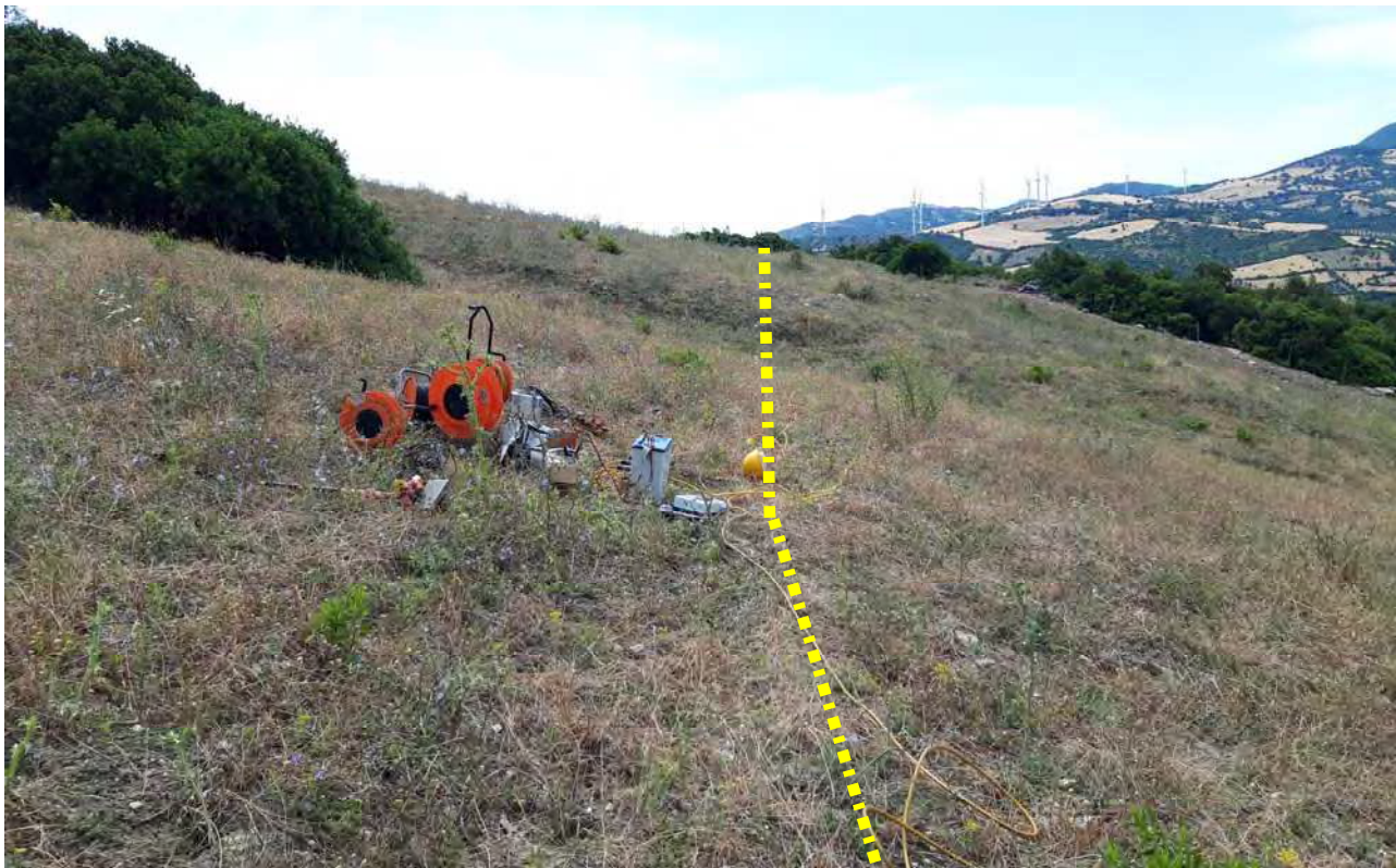
Area di Intervento "C-D" - Postazione Rilievo Goelettrico Tomografico TE2 (vista SE)
