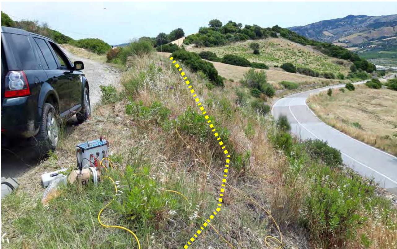
Area di Intervento "E-F" - Postazione Rilievo Goelettrico Tomografico TE3 (vista NE)
